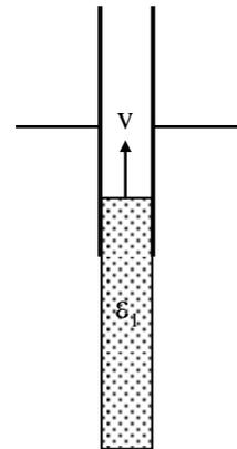
30.0 Ein elektrischer Wasserstands-Melder besteht aus zwei senkrecht stehenden streifenförmigen Metallplättchen ( $b = 5,0 \text{ cm}$ ;  $H = 12 \text{ cm}$ ), die einen Abstand von  $d = 4,0 \text{ mm}$  voneinander haben und an eine Spannungsversorgung mit  $U = 12 \text{ V}$  angeschlossen sind.
