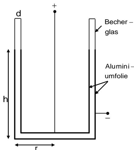
2.1 Berechnen Sie die Kapazität  $C$  dieser Leidener Flasche. [Ergebnis:  $C = 1,7 \text{ nF}$ ]
