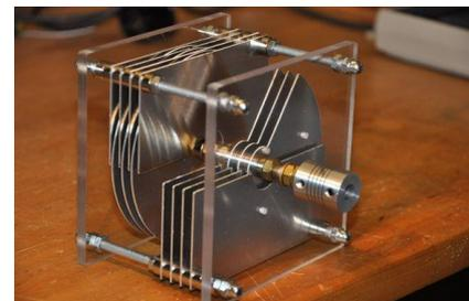
$$\left[ \text{Ergebnis: } C = 28 \text{ pF} \cdot \left( 1 + \frac{\alpha}{30^\circ} \right) \right]$$
