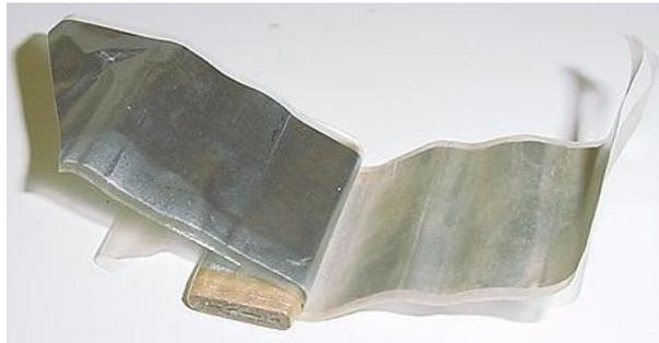
Seiten Metallschichten aufgedampft werden. Eine Metallschicht erhält einen isolierten Überzug und dann werden die Folien zu Rollen aufgewickelt und in einem kleinen Kunststoffbecher luftdicht vergossen (Kapazitätsbereich: 1pF bis 1 $\mu$ F).
