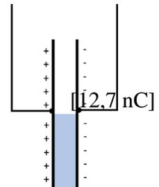
30.2 Zeigen Sie, dass für die Ladung des Kondensators in Abhängigkeit von der Wasserstandshöhe  $h$  gilt:  $Q_{\text{ges}} = \frac{\epsilon_0 \cdot b}{d} \cdot [H + (\epsilon_r - 1) \cdot h] \cdot U$
