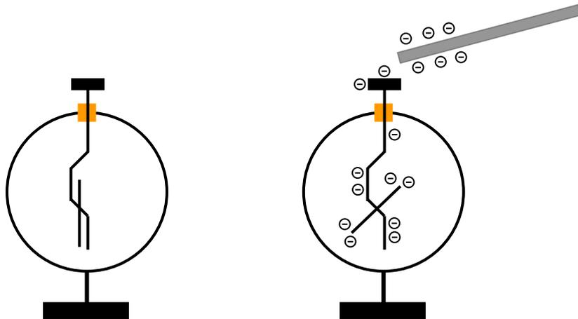
Bringt man an das Elektroskop eine kalibrierte Skala an, dann nennt man es ein Elektrometer.
