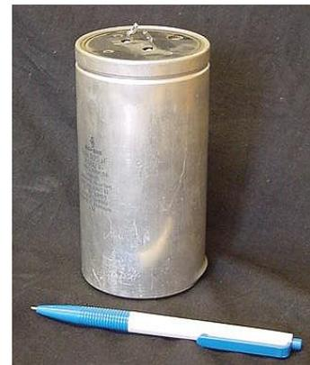
Zusammen mit einer Isolationsfolie werden die Alufolien aufgewickelt und in einem Alubecher luftdicht verschlossen
