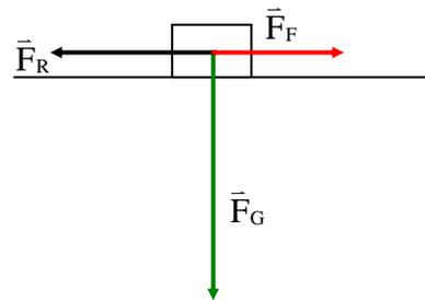
Zum problemlosen Durchfahren einer Kurve muss die Reibungskraft größer oder gleich der für die Kurvenfahrt nötigen Zentripetalkraft sein.
