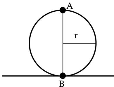
Damit im höchsten Punkt der Faden gerade noch gespannt ist muss die resultierende Kraft im Punkt A null sein. Das heißt, dass die Zentripetalkraft gleich der Gewichtskraft sein muss.
