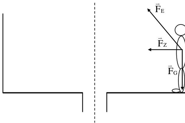
15.2 Nun soll im Rotor der Boden abgesenkt werden, ohne dass ein Körper der Masse  $m$  von der Wand abgleitet. Welche Geschwindigkeit (Betrag) muss die Wand besitzen, wenn die Reibungszahl  $\mu$  vorgegeben ist.
