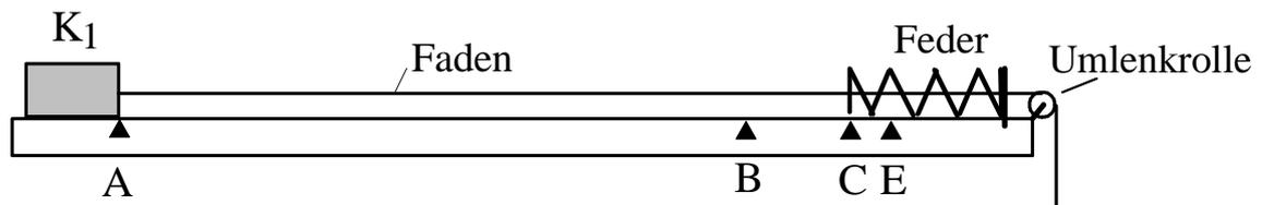
Bei der Bewegung von A nach E ist die Reibungszahl  $\mu$  für die Reibung zwischen dem Holzklötzchen und der Unterlage konstant. Die Massen von Faden, Feder und Umlenkrolle sowie die Reibung im Rollenlager sind in den folgenden Aufgaben zu vernachlässigen.
