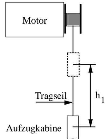
Zum Zeitpunkt  $t_0 = 0$  s startet die Aufzugkabine aus dem Ruhezustand nach oben. Bis zum Zeitpunkt  $t_1 = 3,50$  s legt sie eine Strecke der Länge  $h_1 = 3,50$  m zurück. Auf dieser Strecke erfährt die Kabine die konstante Beschleunigung  $\vec{a}$ .
