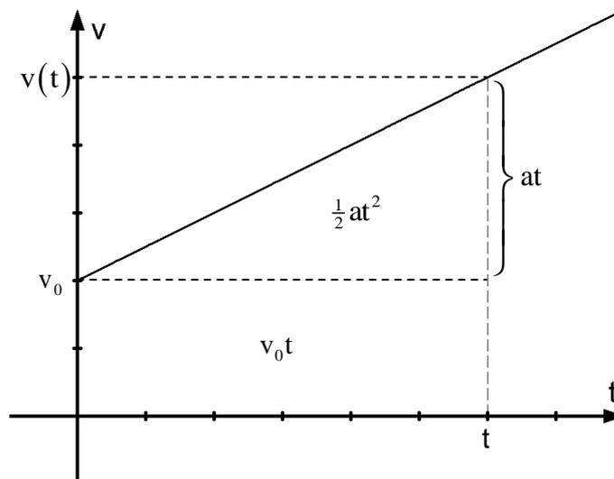
Der in der Zeit  $t$  zurückgelegte Weg entspricht (wie schon bei der gleichförmigen Bewegung) der Fläche, die vom Graph der Zeit-Geschwindigkeitsfunktion und der  $t$ -Achse eingeschlossen wird.
