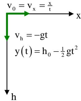
Diese Gleichung nennt man die Bahnkurve eines Körpers, sie beschreibt seine Flugbahn in einem x-h-Diagramm. Bei der Flugbahn handelt es sich um ein „Ast“ einer nach unten geöffneten Parabel.
