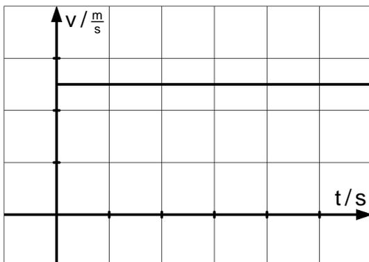
Bei einer Bewegung mit konstanter Geschwindigkeit erhält man eine waagrechte Gerade.
