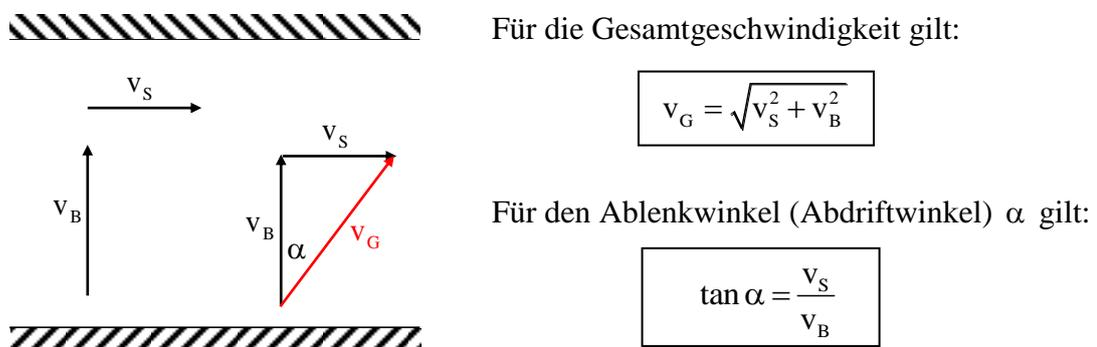
Um zu verhindern, dass man in solch einem Fall abgetrieben wird benötigt man einen Vorhaltewinkel  $\beta$
