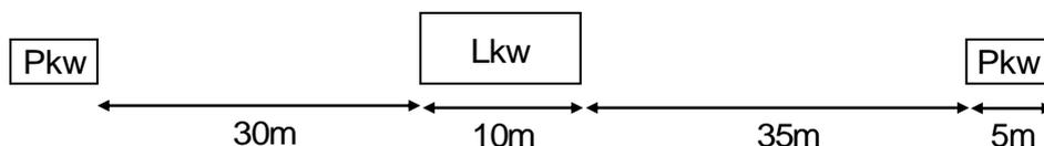
Um den Lkw zu überholen muss der Pkw eine Strecke von  $x = 30\text{m} + 10\text{m} + 35\text{m} + 5\text{m} = 80\text{m}$  zurücklegen (gemessen von der Vorderseite des Pkw). Seine relative Geschwindigkeit, die er effektiv schneller als der Lkw ist beträgt dabei  $v_{\text{rel}} = v_P - v_L = 25 \frac{\text{m}}{\text{s}} - 20 \frac{\text{m}}{\text{s}} = 5 \frac{\text{m}}{\text{s}}$ . Somit folgt für die Überholzeit  $t_{\text{Ü}}$ :
