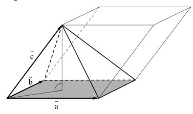
$$V_{\text{4-seitige Pyramide}} = \frac{1}{3} \cdot \left| \left( \vec{a} \times \vec{b} \right) \circ \vec{c} \right| = \frac{1}{3} \cdot \left| \det \left( \vec{a}, \, \vec{b}, \, \vec{c} \right) \right|$$
